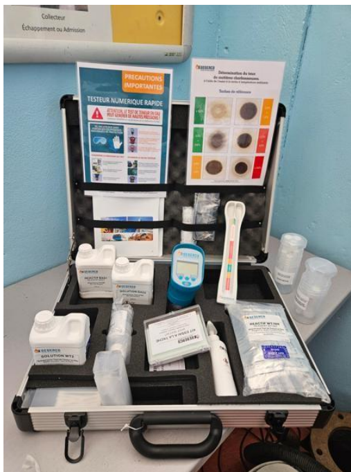
Valise contenant les dispositifs d'analyse du combustible des moteurs Diésel.
