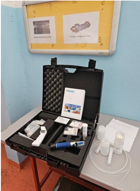
Valise contenant les dispositifs d'analyse de l'eau douce de réfrigéra- tion d'un moteur Diésel.
