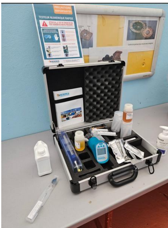
Valise contenant les dispositifs d'analyse huiles de lubrification des moteurs Diésel.
